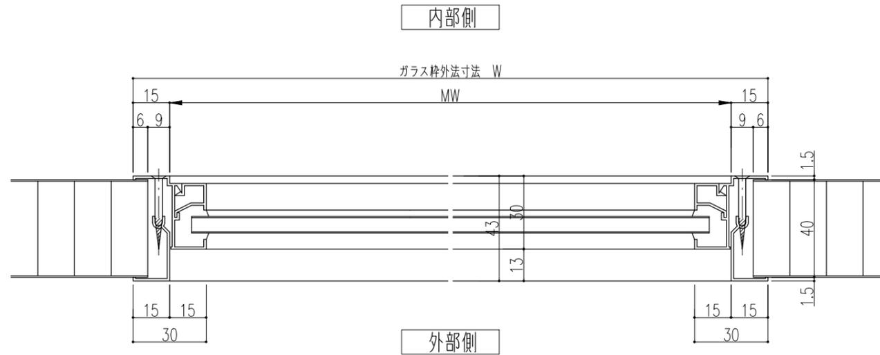
\*MH×MWの押えは、扉端部（上下左右）から150mmを確保して下さい。
